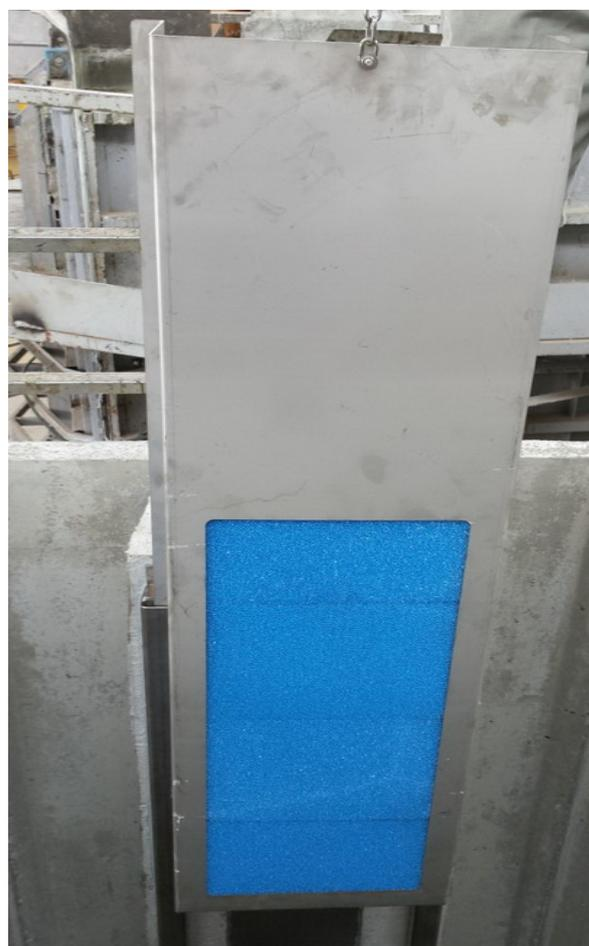
Filtro a coalescenza dotato di slitta di estrazione per la pulizia e/o la sostituzione del materiale filtrante
