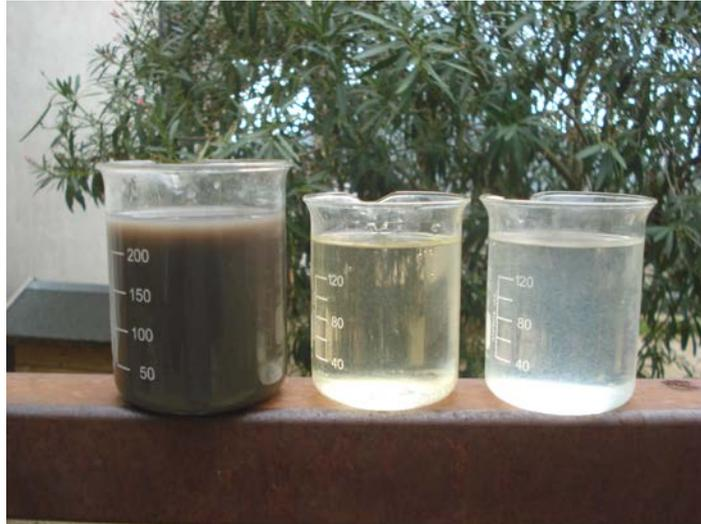
Come già detto precedentemente, il fango di risulta dalla depurazione chimico-fisica viene in genere disidratato sul posto mediante un disidratatore a sacchi drenanti. Il fango risultante ha un contenuto secco dell'80% per cui risulta palabile e conferibile in discarica oppure utilizzabile in agricoltura.
